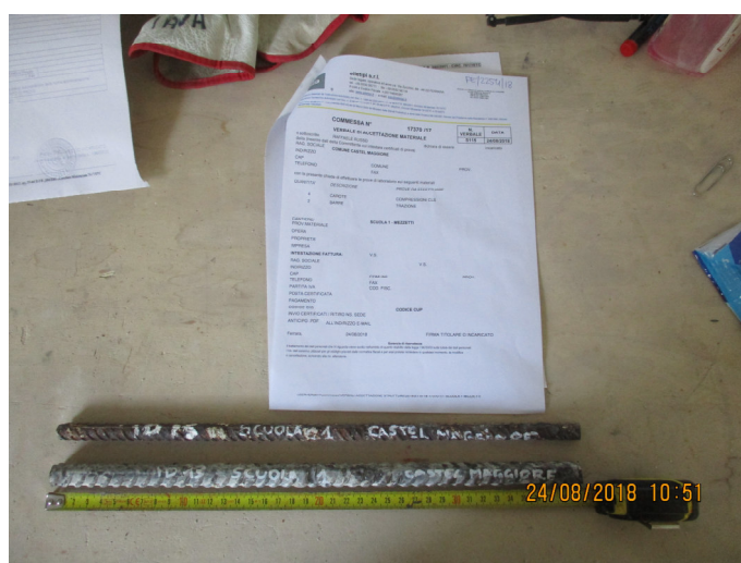
Figura 17 –barre d'armatura prelevate in sito
