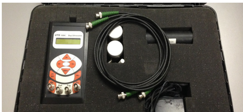
Figura 10 - ultrasuoni DSP Ultrasonic UTD 1004
