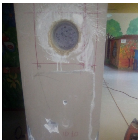
Figura 4 - carotaggio eseguito su pilastro
