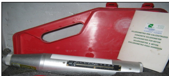
Figura 7 - sclerometro per calcestruzzo TRIMTEC
