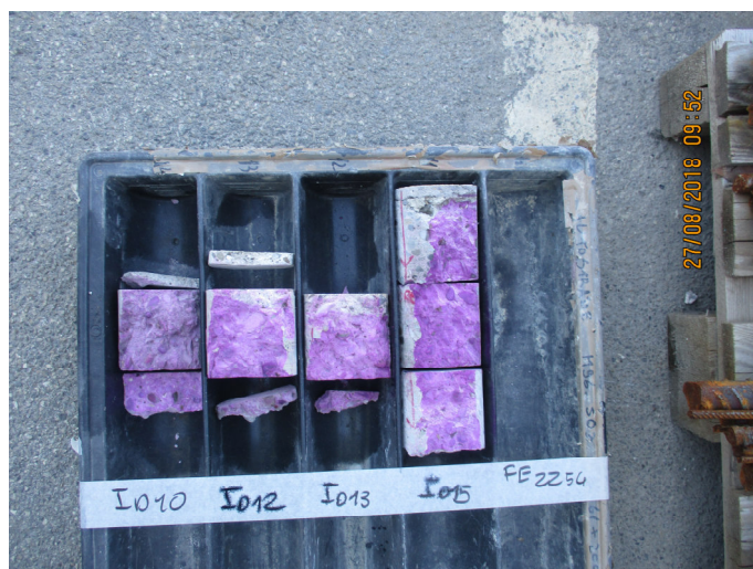
Figura 16 - cilindri in cls carbonatati.
